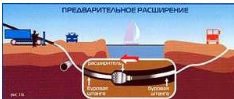
Расширение скважины осуществляется после завершения пилотного бурения. При этом буровая головка отсоединяется от буровых штанг и вместо нее присоединяется риммер - расширитель обратного действия. Приложением тягового усилия с одновременным вращением риммер протягивается через створ скважины в направлении буровой установки, расширяя пилотную скважину до необходимого для протаскивания трубопровода диаметра. Для обеспечения
