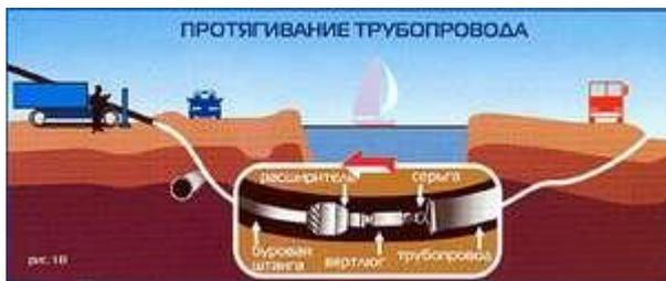
Протягивание футляра и трубопровода на противоположной от буровой установки стороне скважины располагается готовая к протягиванию плеть трубопровода. К переднему концу плети крепится оголовок, оголовок цепляется за вертлюг с расширителем.
